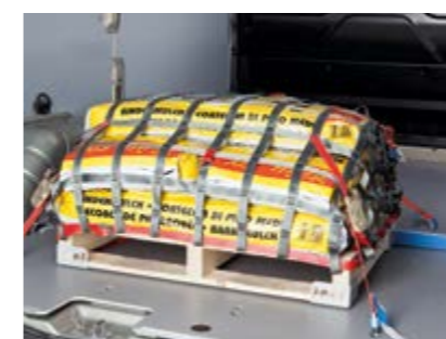
Kombineret last, der sikrer net- og tværbjælker
